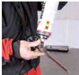
Po úplném vyprázdnění dózu odšroubujte z pistole a ihned nahradte novou dózou
