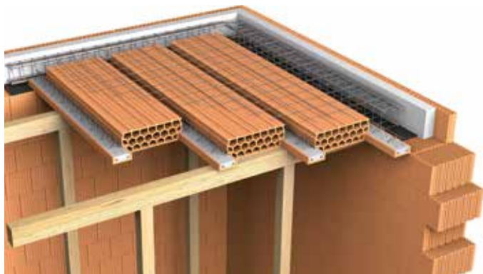
Uložení stropních vložek MIAKO, vyrovnaní ztužujících věnců a položení sítě
