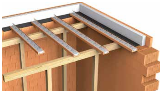
Položení trámů na zdivo a předem připravené podpory
