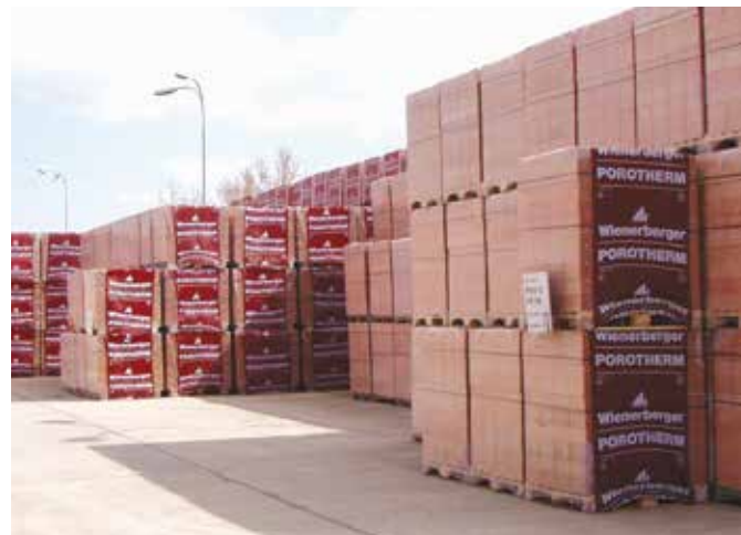
Výrobky na paletách je nutné skladovat na vodorovném a odvodněném podkladu, nejlépe na betonové, asfaltové, panelové či jinak zpevněné ploše
